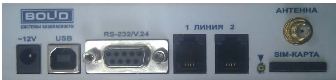
Рисунок 1. Задняя крышка «УОП-3 GSM» с разъёмами
